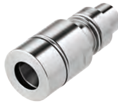
Präzisions-Spannzangenfutter ER für Spannzangen ISO 15488 (DIN 6499) System ER Precision collet chuck ER for collets ISO 15488 (DIN 6499) ER-system Mandrin à pinces ER de précision- pour pinces ISO 15488 (DIN 6499) système ER
