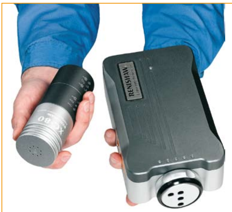
Laser XL-80 (z opcjonalną przesłoną uniwersalną) i kompensatorem XC-80
