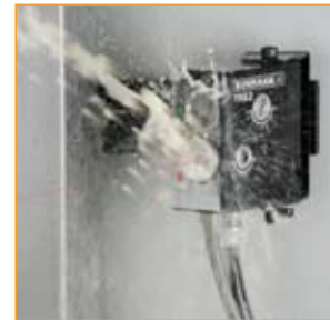
TRS2 – system sprawdzania narzędzi
