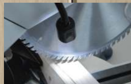
Elastyczna lampa diodowa (osprzęt) na elastycznym wysięgniku oświetla miejsce pracy.
