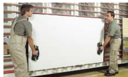
Za pomocą GECKO można pewnie i wygodnie uchwycić gładkie i nieporęczne przedmioty.
