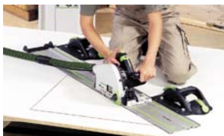
Pewne i delikatne mocowanie szyny: po prostu przymocować adapter do szyny prowadzącej, natożyć GECKO, zamocować – gotowe.
