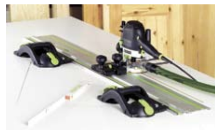
Z GECKO prostsze staje się także frezowanie wpuście w przedmiotach o gładkiej powierzchni: należy tylko zamontować adapter i przymocować przyssawkami.
