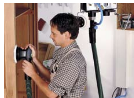
Dzięki niewielkiemu ciężarowi i bardzo dużej poręczności szlifierki mimośrodowe LEX 2 bardzo dobrze nadają się też do pracy na pionowych powierzchniach.
