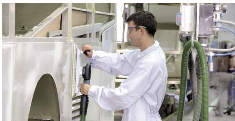
Opracowane specjalnie dla warsztatów: szlifierki mimośrodowe LEX 2 i system IAS 2 z odkurzaczem mobilnym.
