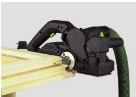
Nieograniczona głębokość wykonywania wręgów dzięki jednostronnemu ułożeniu głowicy nożowej.
