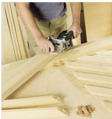
Stabilne połączenia ramowe na zewnątrz
