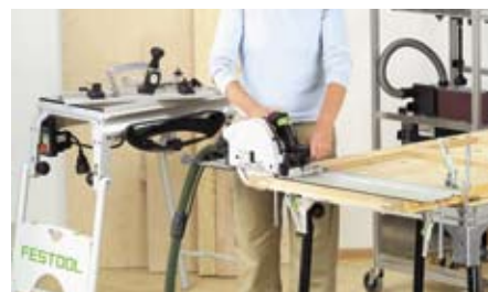
Wbudowane maszyny mogą być stosowane nie tylko stacjonarnie, lecz także z prowadzeniem ręcznym – zmiany charakteru pracy dokonuje się błyskawicznie.
